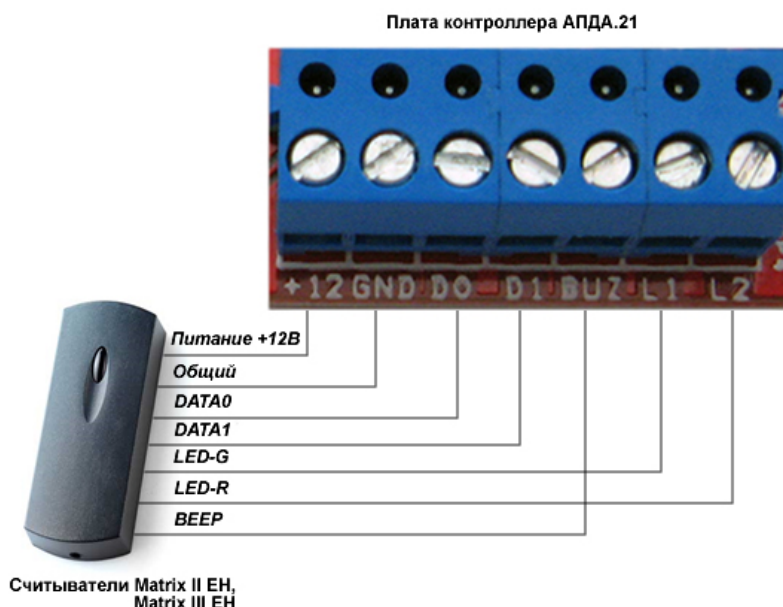
Рисунок 3 – Схема подключения считывателей
